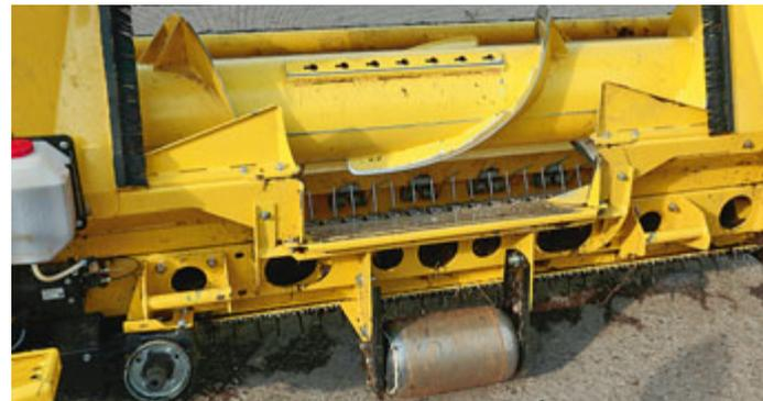
Die neue Pickup 639 von Kemper kommt ohne gesteuerte Einzugsfinger aus und verfügt über eine zusätzliche Taster aus Stahl. Die Pickup-Drehzahl ist mit der Fahrgeschwindigkeit, die Schneckendrehzahl mit den Vorpressewalzen synchronisiert.
