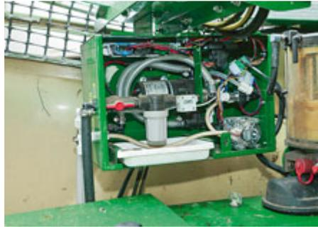
Unter der Haube scheint noch Platz für mehr PS (links). Rechts: die integrierte Siliermittelpumpe.
