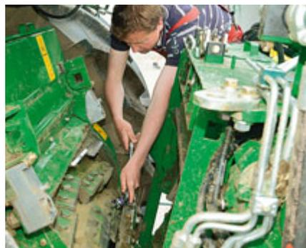
Der Vorpressekanal kann jetzt auch nach oben aufgeklappt werden.
