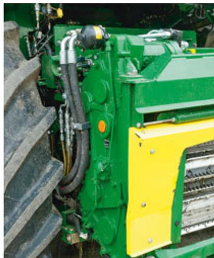
*Leicht, schmal und dennoch durchzugsstark: der neue hydraulische Vorpressewalzen-Antrieb.*
