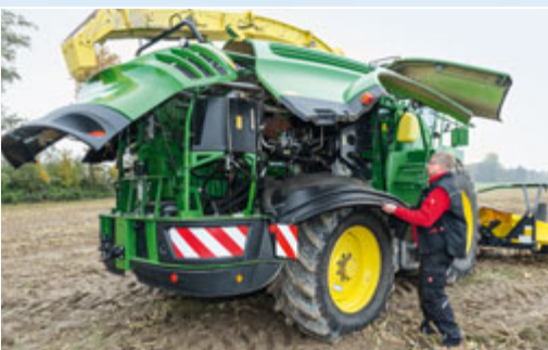
Die Zugänglichkeit ist gut. Die Kotflügel montiert man besser zu zweit, die offene Wartungsraumklappe ist kaum erreichbar.
