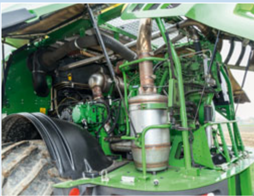
Der 9-l-Motor mit 431 PS Maximalleistung zeigte im Test ein gutes Standvermögen.
