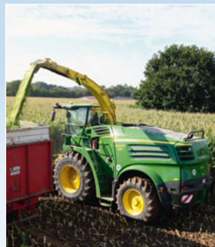
Mit seiner theoretischen Durchsatzleistung von 51 bis fast 55 t/h Trockenmasse braucht sich der „kleine“ 8200i nicht zu verstecken.
