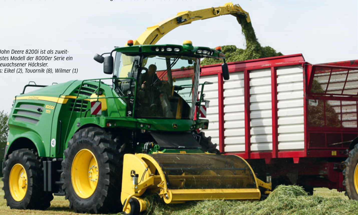
Mit seiner theoretischen Durchsatzleistung von 51 bis fast 55 t/h Trockenmasse braucht sich der „kleine“ 8200i nicht zu verstecken.
