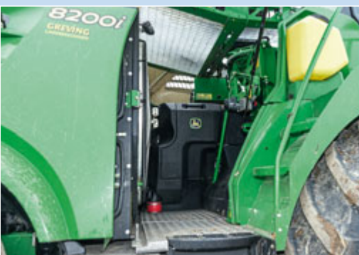
Der Wartungsraum bietet viel Platz, nicht nur zum Wechsel zwischen Cracker und Graskanal.
