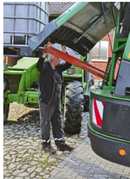
Der 300-l-Siliermitteltank lässt sich leider nur umständlich befüllen.
