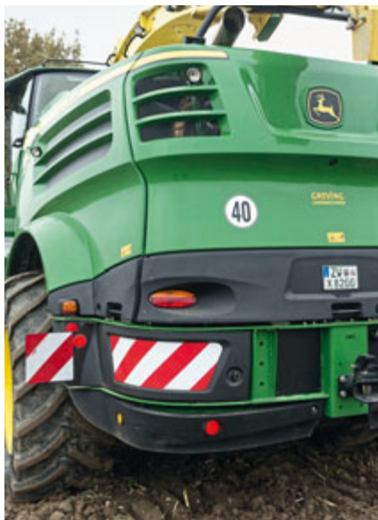
Am Heck fehlt ein stabiler Anfahrtschutz. Vor allem die schwarzen Kunststoffverkleidungen ganz unten sind stark gefährdet.
