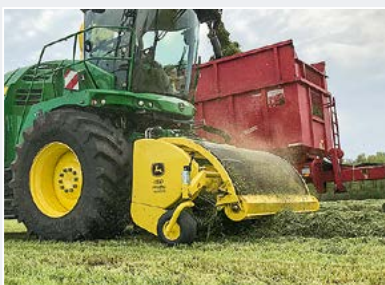
Die Pickup zieht die Schwaden auseinander und füttert das Häckselaggregat gut.
