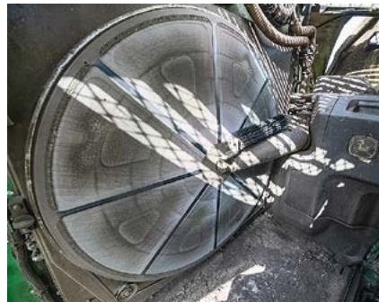
Mit neu eingestellter Rollenbürste ist die Kühlerreinigung perfekt.
