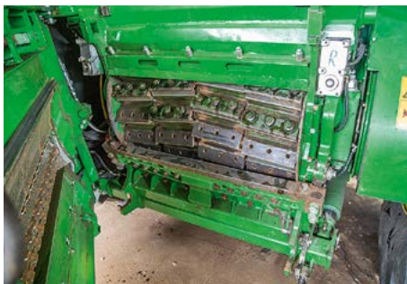
Die Vielmessertrommel mit 64 Messern leistet saubere Arbeit. Nach nunmehr 1600 ha im Mais ist punktueller Verschleiß an den Seiten des Häckselkanals erkennbar, sowohl bei den Vorpresswalzen als auch beim Körnerprozessor.
