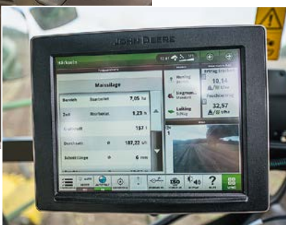
Die Kabine bietet viel Platz und beste Rundumsicht. Alle wichtigen Infos werden logisch im A-Holm oder auf dem kleinen Terminal angezeigt. Das 4640 Terminal rechts ist nachgerüstet worden, um die Genauigkeit der Ertragsfassung zu erhöhen.
