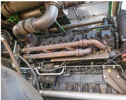
Der längs eingebaute Liebherr V12 dreht mit maximal 1800 U/min und hat 3940 Nm.
