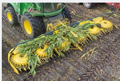
Der Anstellwinkel des Maisvorsatzes wurde flacher eingestellt. Der Gutfluss ist besser.
