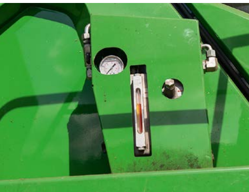
Ein Hahn muss geöffnet werden, damit die Körnerprozessor-Lager geschmiert werden.
