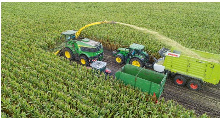
Die Wurfleistung des Gebläses mit zehn Paddeln passt. Auf eine automatische Anhängerbefüllung wurde verzichtet. Die Aufbereitung des Häckselgutes mit dem XStream-Prozessor ist sehr gut.
