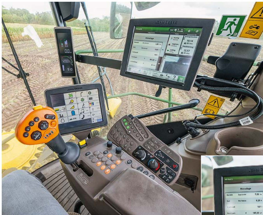
Die Kabine bietet viel Platz und beste Rundumsicht. Alle wichtigen Infos werden logisch im A-Holm oder auf dem kleinen Terminal angezeigt. Das 4640 Terminal rechts ist nachgerüstet worden, um die Genauigkeit der Ertragsfassung zu erhöhen.
