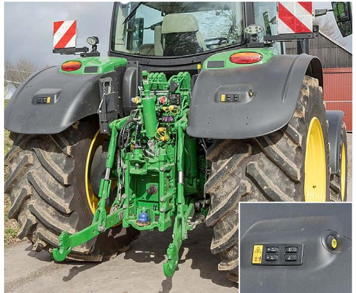
Hubkraft und Hydraulik sind für die 200-PS-Klasse ausgereizt. Wen die langen Kotflügel stören, der kann kurze ordern. Die Ventilbedienung ist nicht frei programmierbar, wurde aber von Ventil III auf IV gewechselt.
