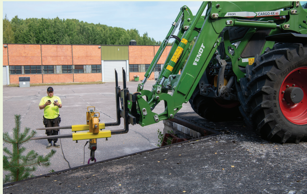
Wir haben zunächst die Hubkraft der Frontlader bei verschiedenen Motordrehzahlen und dann die Ausbrechkraft durch Ankippen der Palettengabel gemessen. Die Frontlader von John Deere und Valtra sind etwa gleich stark, der Fendt-Frontlader hebt etwas weniger.
