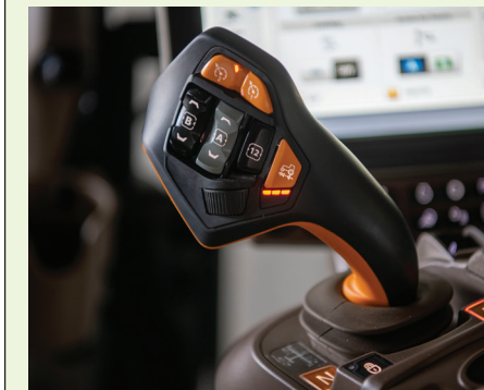
Der Joystick ist sehr ergonomisch – auch wenn nicht jeder Daumen alle Tasten gut erreicht (Taste B, Getriebeaggressivität).
