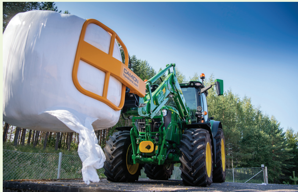
Die Wiegeeinrichtungen erwiesen sich als erstaunlich genau. Wir haben sie überprüft, indem wir die Rundballen zuerst auf einer geeichten Standwaage und dann mit den Wiegesystemen der Frontlader gewogen haben. Bei keinem Schlepper war die Abweichung größer als 20 kg pro Ballen.
