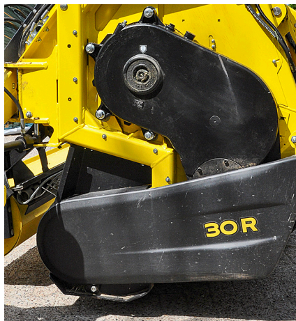
Ein Ölbadgetriebe ersetzt alle Ketten – das spart Wartungszeit.
