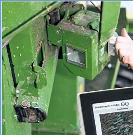
ICA2 nutzt Kamerabilder aus der Überkehr und dem Kornelevator für die Einstellung. Die Bildanalysen werden auch angezeigt.
