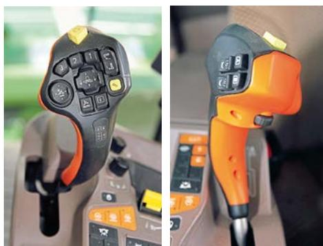
Links die komplette CommandArm-Armlehne. Der Joystick liegt prima in der Hand und wartet mit Scrollrad für das Display sowie insgesamt fünf belegbaren Tastern auf.
