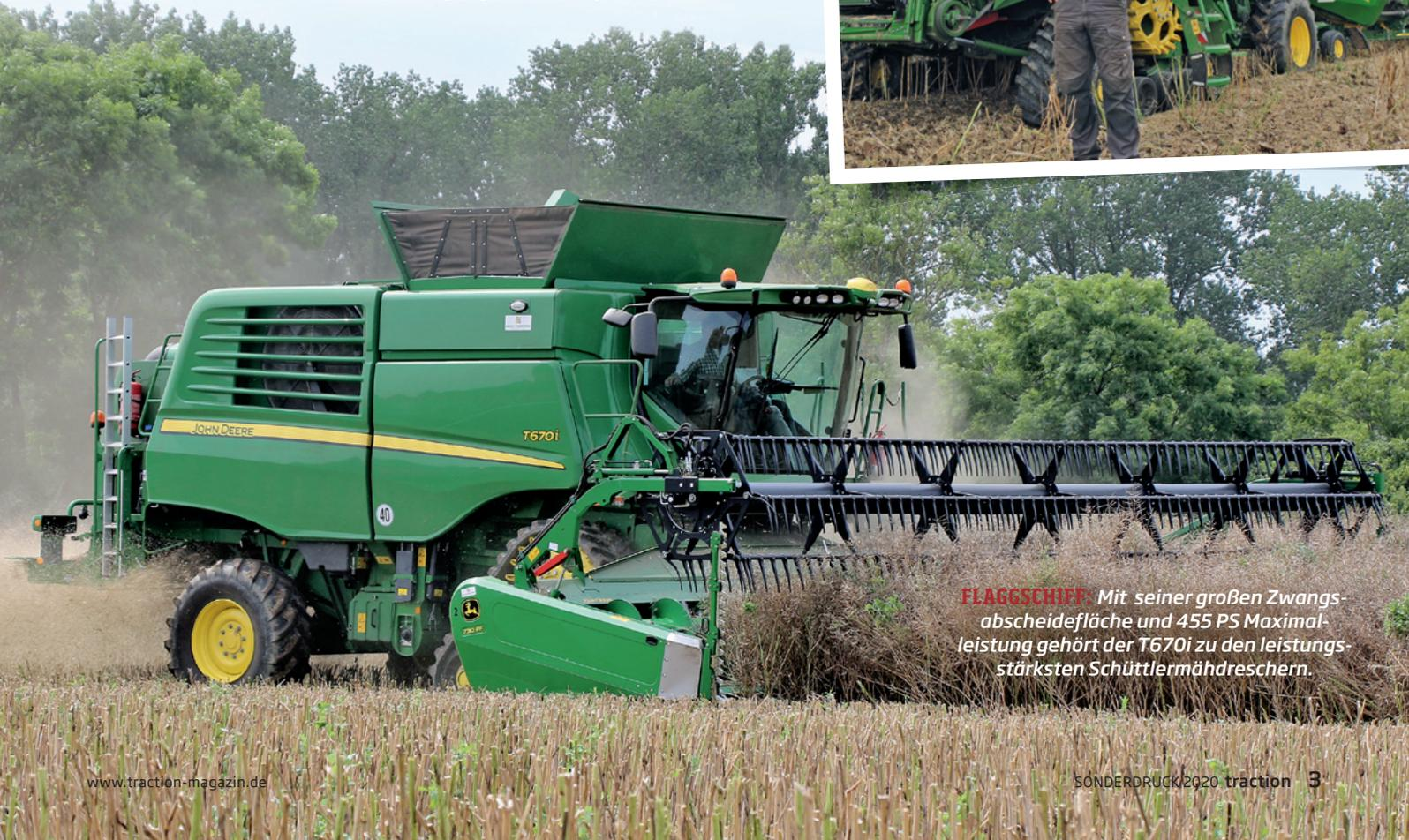
**FLAGGSCHIFF:** Mit seiner großen Zwangsabscheidefläche und 455 PS Maximalleistung gehört der T670i zu den leistungsstärksten Schüttlermähdreschern.
