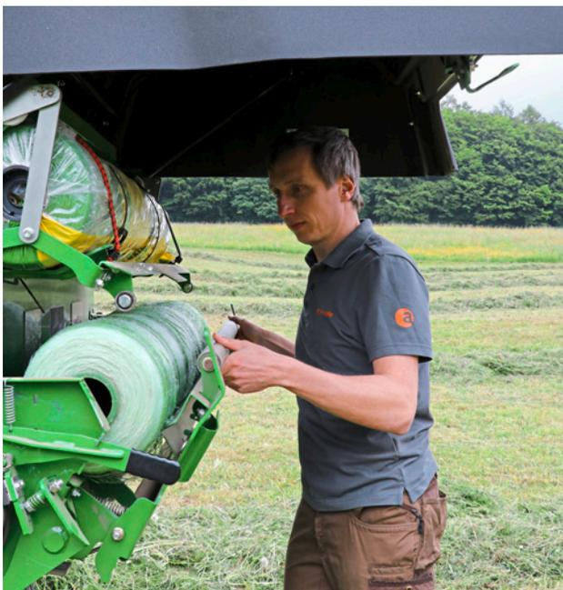
Bodenständig: Der Netzwechsel an der Heckklappe geht einfach.
